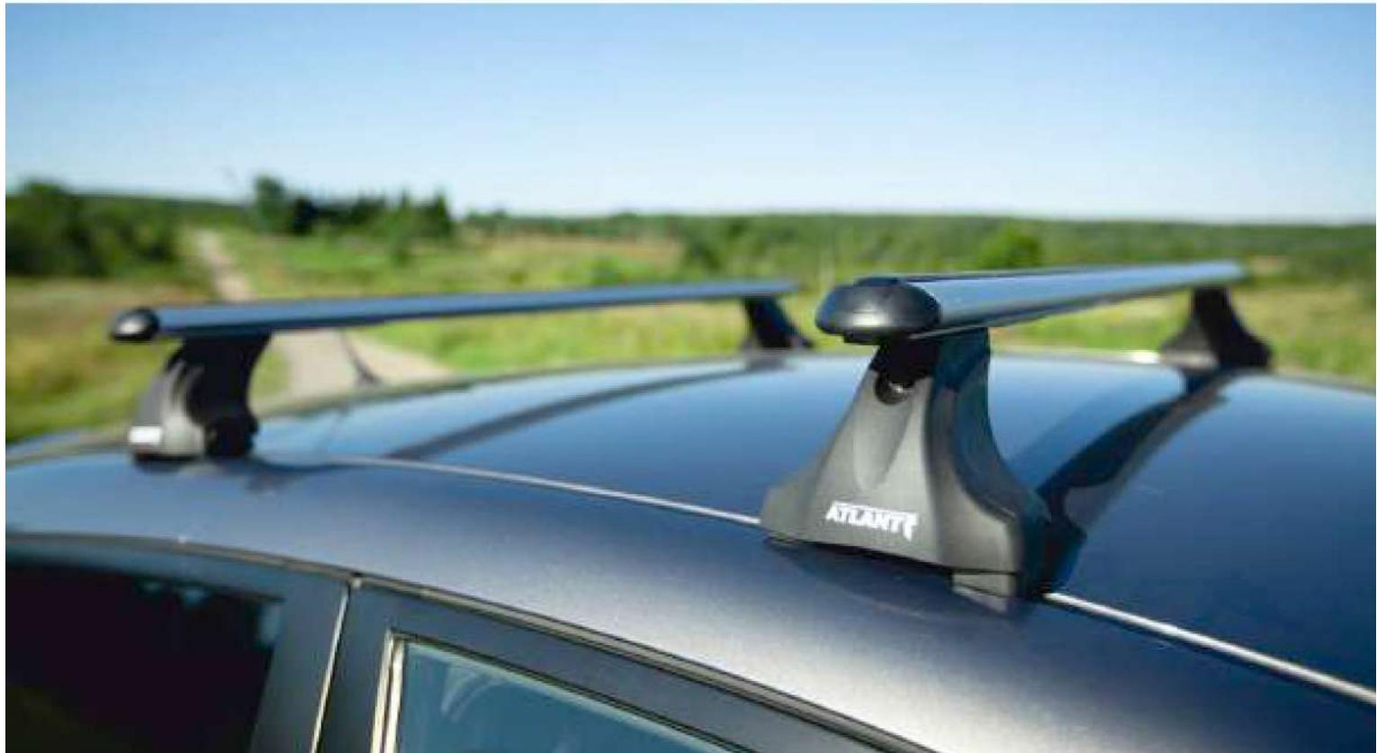
С помощью винтов багажник устанавливается в штатные места автомобиля.
