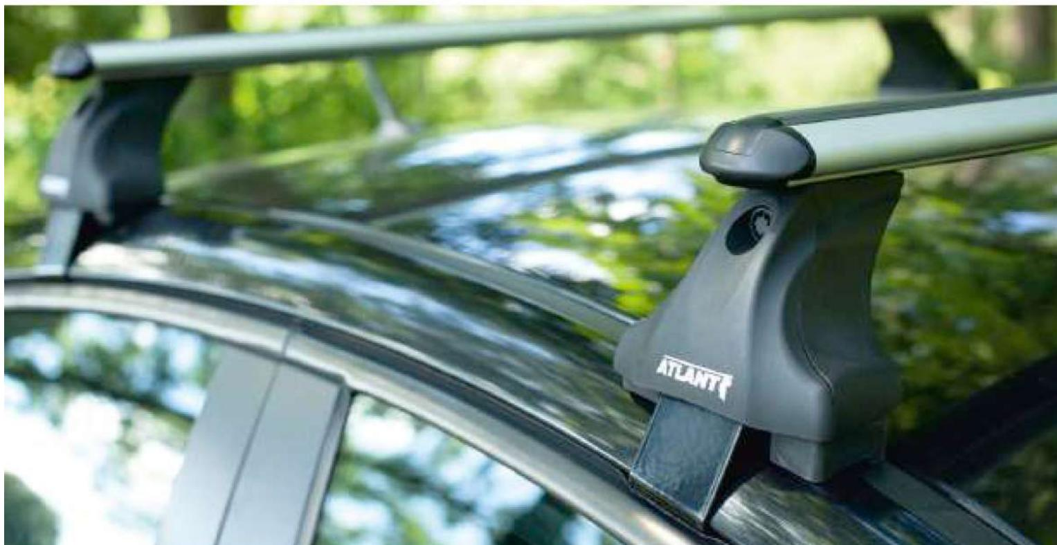
С помощью прижимов багажник фиксируется за дверной проем.
