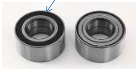
Die ASB®-Testkarte benutzen, um die Seite mit dem ASB®-Magnetencoder zu identifizieren und zu prüfen.
