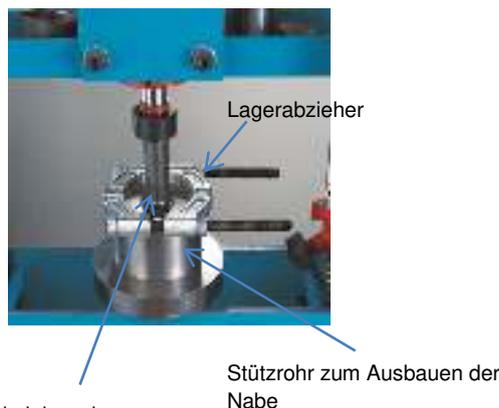
Rohr zum Abziehen des Lagerinnenrings von der Nabe: Der Durchmesser muss kleiner sein als die Bohrung des Lagerinnenrings
