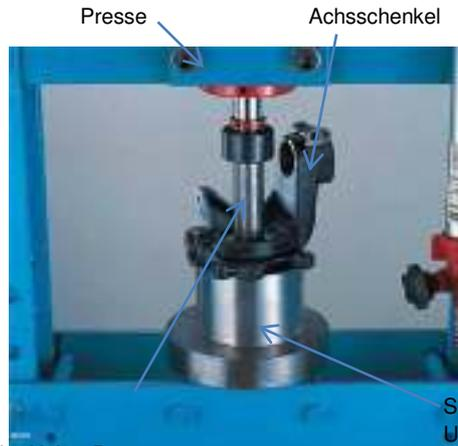
Rohr zum Abziehen der Nabe: Der Durchmesser muss kleiner sein als die Bohrung des Lagerinnenrings
