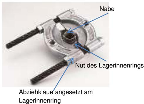
5. Den Abzieher auf die Presse setzen und mit einem Rohr oder Unterlegscheiben unterbauen. Mit dem genannten passenden Rohr (siehe Punkt Nr. 2) die Nabe aus dem Lagerinnenring ausdrücken.
