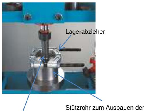
Rohr zum Abziehen des Lagerinnenrings von der Nabe: Der Durchmesser muss kleiner sein als die Bohrung des Lagerinnenrings
