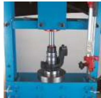
\*\*le diamètre du tube doit correspondre à la surface de poussée sur la bague extérieure.
