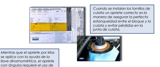
La falta de apriete del tornillo implica fuerzas de cierre insuficientes y por tanto pérdidas de líquidos y gases en la junta de culata; mientras que si este es excesivo se sobrepasará la zona plástica del tornillo llegando a la rotura del mismo. Del mismo modo reutilizar tornillos de apriete angular puede provocar la insuficiencia del cierre en la culata e incluso la rotura del tornillo de forma inesperada antes de completar el apriete.
