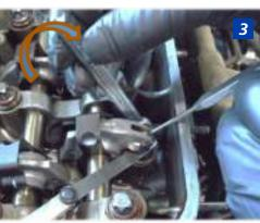
2. Ajustar la arandela excéntrica con la cabeza de la válvula introduciendo una galga calibrada de **0.25 mm** entre ambas.
