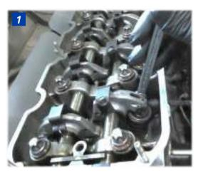
3. Apretar la tuerca para fijar la excéntrica en la posición correcta con la galga situada entre ésta y la cabeza de la válvula.
