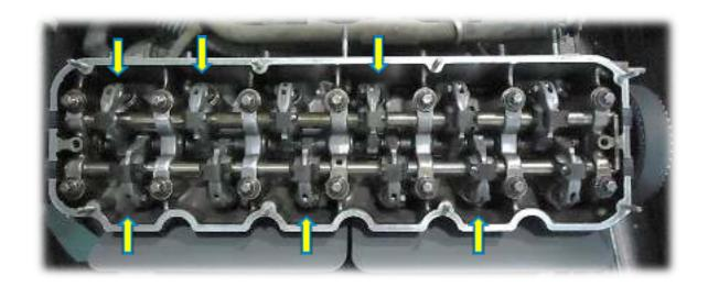
5. Una vez ajustadas todas las válvulas, proceder al montaje de la tapa de balancines instalando una nueva (11031000) y realizar el apriete especificado.
