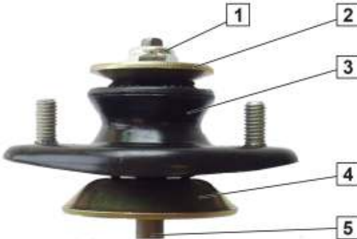
Abb. / Fig. 1: Stoßdämpfer mit Federbeinstützlager Shock absorber with suspension strut mount Amortisseur avec semelle de suspension Amortiguador con soporte del puntal de suspensión
