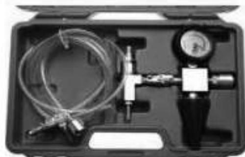
Pour toute intervention effectuée sur le circuit de refroidissement, il faut impérativement purger celui-ci avec **un purgeur à vide standard**. Cela permettra d'éviter les moindres bulles d'air, afin de ne pas provoquer de surchauffe du moteur.
