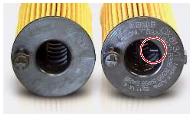
Abbildung 2: Führungsnase ist deutlich zu erkennen: Links OX404 ohne und rechts OX813/1 mit
