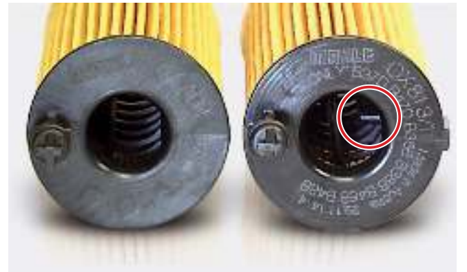
Resim 2: Kılavuz burun açıkça belli oluyor: Soldaki OX404'te yok ve sağdaki OX813/1'de var
