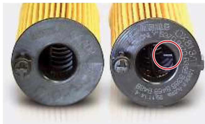
Ilustracja 2: Wyraźnie widoczny nosek prowadzący: po lewej stronie OX404 bez niska i po prawej stronie OX813/1 z noskiem
