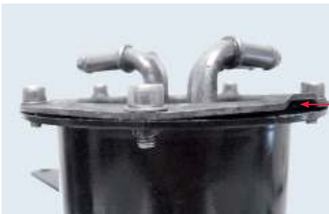
Bild 1: Dieser Gehäusedeckel (KX 178) wurde durch fehlerhaftes Öffnen und/oder Schließen verformt.
