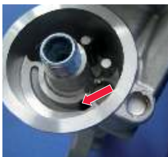
Figure 1 : Vue du flasque avec plaque antiretour côté moteur.
