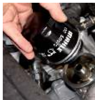
Figure 3 : Lors du desserrage du filtre usagé, veillez absolument à ce que l'huile moteur ne coule pas sur l'entraînement de courroie ou dans l'alternateur.
