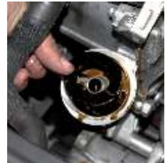
Figura 4: La junta antigua puede quedar pegada en la brida, y es imprescindible eliminarla.
