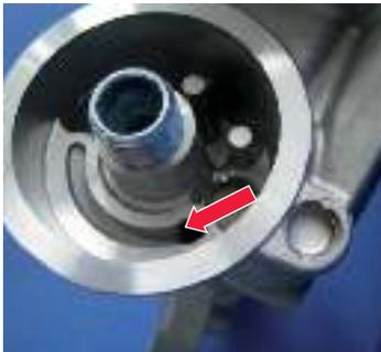
Figura 1: Vista de la brida en el lado del motor con canal de vaciado reniforme
