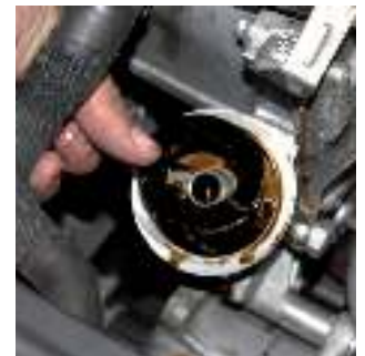
Εικόνα 4: Η παλιά φλάντζα μπορεί να μείνει κολλημένη στη φλάντζα και πρέπει να απομακρυνθεί οπωσδήποτε.
