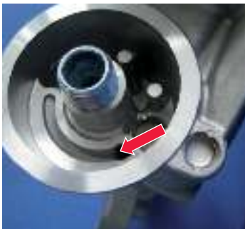
Εικόνα 1: Ματιά στη φλάντζα, που βρίσκεται στην πλευρά του κινητήρα, με νεφροειδές ρελαντί
