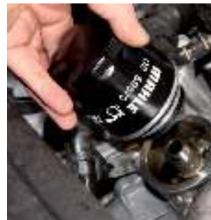
Εικόνα 3: Λασκάροντας το παλιό φίλτρο, προσέξτε ώστε να μην εισχωρήσει λάδι κινητήρα στην κίνηση ιμάντα ή στη γεννήτρια.
