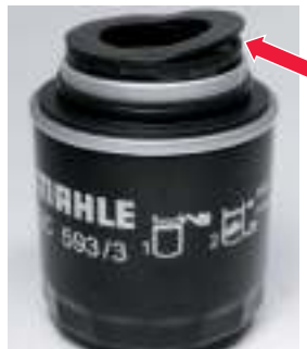
Εικόνα 2: Η επάνω φλάντζα (ανασηκωμένη προς διευκρίνιση) αναλαμβάνει το κλείσιμο του μηχανισμού ρελαντί στη φλάντζα
