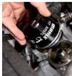
Ilustracja 3. Podczas wykręcania starego filtra należy uważać, aby olej silnikowy nie kapał na napęd pasowy ani na alternator.
