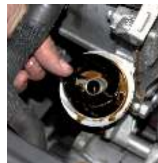
Ilustracja 4. Stara uszczelka może przywrzeć w kołnierzu, wówczas bezwzględnie należy ją wyjąć.
