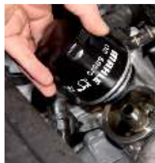
Рисунок 3: При демонтаже старого фильтра необходимо следить за тем, чтобы моторное масло не попадало на ременный привод или внутрь генератора.
