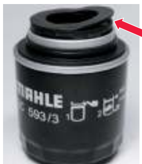
Рисунок 2: Верхняя прокладка (приподнята для лучшей наглядности) служит для перекрывания механики слива масла во фланце.
