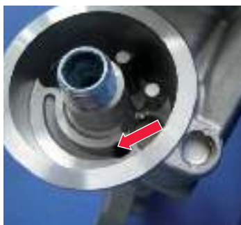
Рисунок 1: Вид на фланец и овально-изогнутый элемент холостого хода со стороны двигателя.
