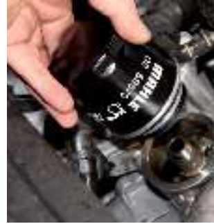
Resim 3: Eski filtreyi sökerken, motor yağının kayışlı tahrike veya alternatöre ulaşmamasına dikkat edilmelidir.
