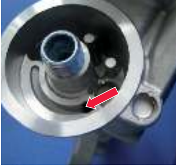
Resim 1: Motor tarafındaki drenaj önleme plakalı flanşın görünümü
