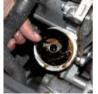
Resim 4: Eski conta flanşın içerisinde yapışmış olarak kalabilir ve mutlaka çıkarılması gerekir.
