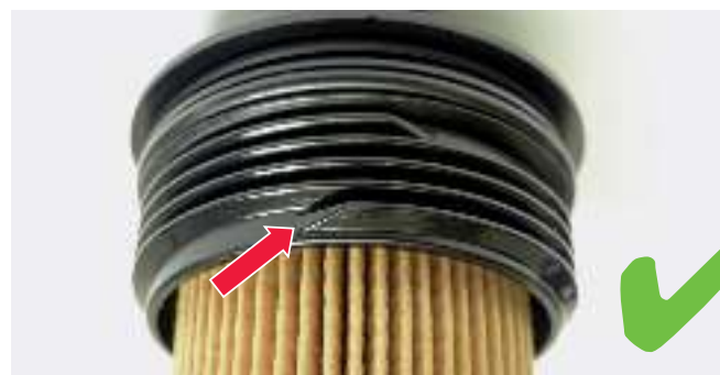
Figure 3 : Filetage en bon état
