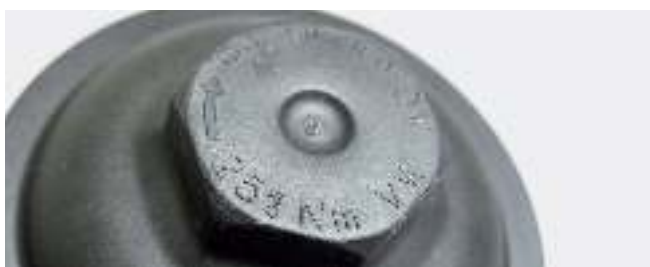
Рисунок 2: Величина требуемого момента затяжки указана на крышке корпуса
