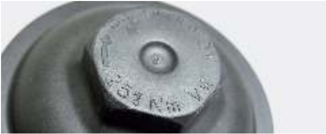
Resim 2: Kapak üzerindeki tork bilgisi
