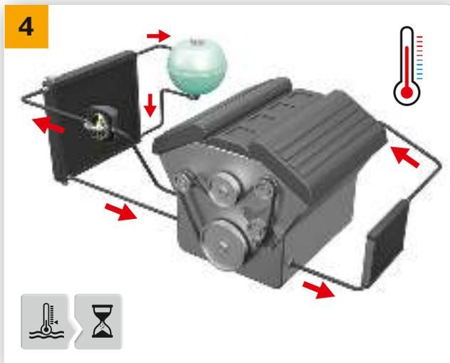
→ Motor auf Betriebstemperatur bringen, damit das Kühlmittelthermostat den großen Kühlkreislauf öffnet. Heizung auf höchste Stufe einschalten, Einwirkzeit nach Herstellervorgaben des Produktes beachten.
