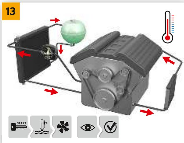
→ Probefahrt oder Probelauf durchführen, bis die Betriebstemperatur erreicht ist. Danach nochmals Dichtigkeit und Füllhöhe des Systems überprüfen (**Achtung Verbrühungsgefahr!**).
