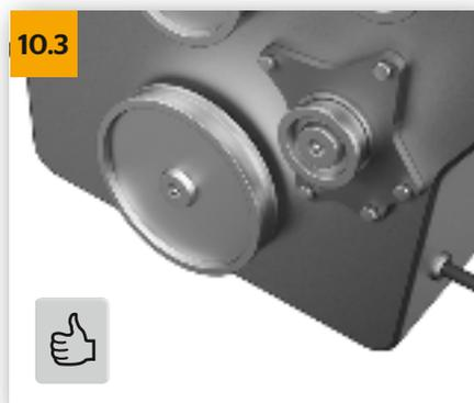
→ Se con la pompa dell'acqua è fornito in dotazione un elemento di tenuta o una guarnizione circolare, non è consentito utilizzare pasta sigillante! Prima del montaggio, bagnare le guarnizioni circolari preassemblate con liquido di raffreddamento, ma non con grasso.
