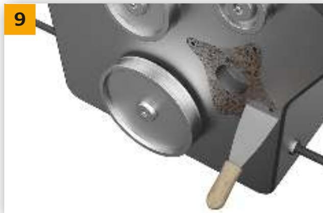
→ A questo punto, smontare la vecchia pompa dell'acqua e pulire e sgrassare accuratamente le superfici di tenuta.
