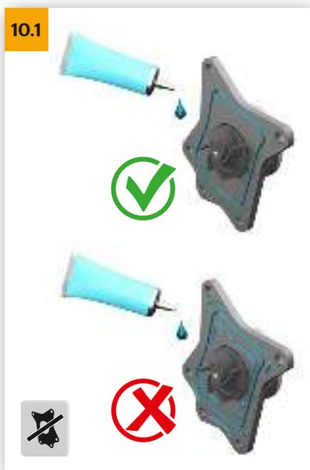
→ Montare la nuova pompa dell'acqua seguendo le istruzioni del costruttore. Attenersi assolutamente alle coppie di serraggio e alle istruzioni per l'impiego di guarnizioni/sigillanti.
