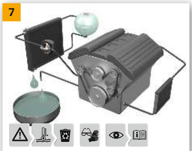
→ Llenar el circuito de refrigeración con agua limpia. Poner el motor a la temperatura de funcionamiento a 2.500 r. p. m. y purgar nuevamente el agua como se ha descrito en los pasos 1 y 5.
