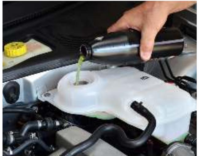
→ Mezclar agua limpia con productos de limpieza (p. ej., MB A0009891025, Liqui Moly 3320, etc.) en la proporción correcta y verter la mezcla en el sistema de refrigeración.
