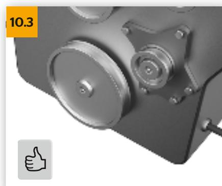
→ Si la bomba de agua ha sido suministrada con una junta o está premontada una junta tórica, no debe usar ningún tipo de masa selladora! Las juntas tóricas premontadas deben humedecerse con refrigerante antes del montaje; no usar grasa.
