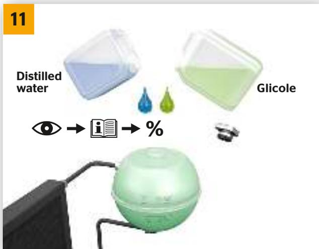
→ Echar el refrigerante nuevo en el sistema de refrigeración en la proporción de mezcla de refrigerante y agua correcta. Para ello, utilizar solamente los concentrados refrigerantes autorizados para el vehículo. Dependiendo del fabricante del vehículo y del año de fabricación del modelo, se aplicarán diferentes valores límite para el agua utilizada (grado de dureza, valor pH, etc.). En caso de duda, use agua destilada.
