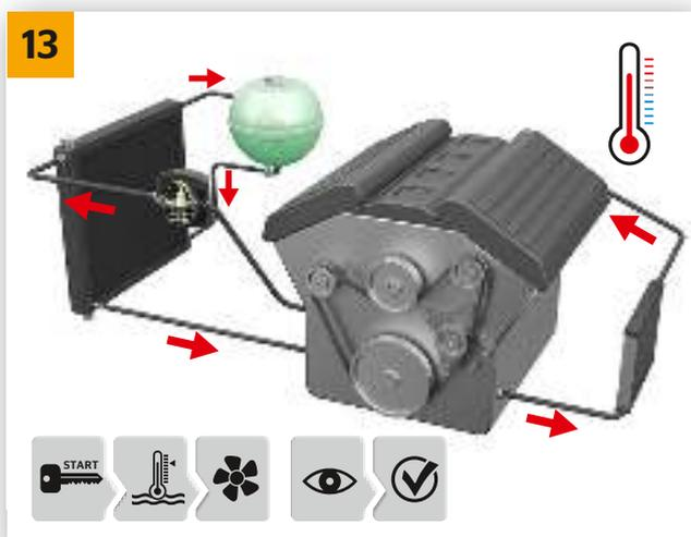
→ Realice una prueba de conducción o de funcionamiento hasta que se alcance la temperatura de funcionamiento. A continuación, comprobar de nuevo la estanqueidad y el nivel de llenado del sistema (**atención: existe peligro de escaldaduras!**).
