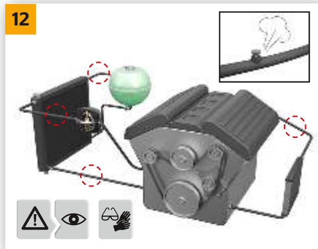
→ Purgar el aire del circuito de refrigeración (usar el aparato de llenado si es necesario) conforme a las especificaciones del fabricante y comprobar su estanqueidad. Es posible que se produzca una salida de agua pequeña durante poco tiempo en el orificio de drenaje de la bomba de agua, que cesará poco tiempo después.
