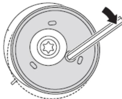
Figure 3 Version 2 - Retirer la goupille après la pose de la courroie
